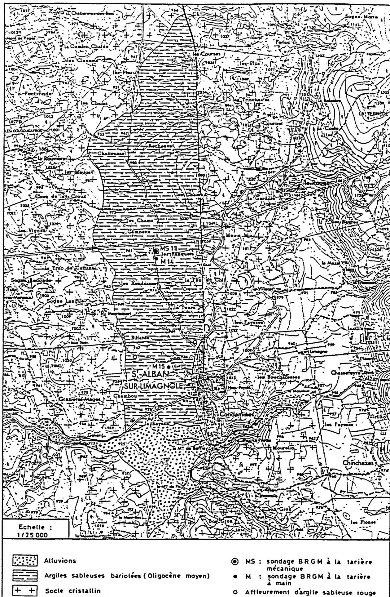
Fig. 19 - Localisation des sondages et prélèvements réalisés dans le bassin de Saint-Alban.
